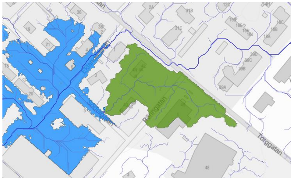
Figur 3 Bilden ovan är ett skärmdörm från Scalgo som redovisas i tillhörande dagvattenanalys som redovisar ytliga avrinningsvägar med de blå linjerna. Det grönmärkade området, som berör planområdet, utgör ett delavrinningsområde till det blå markerade området.
