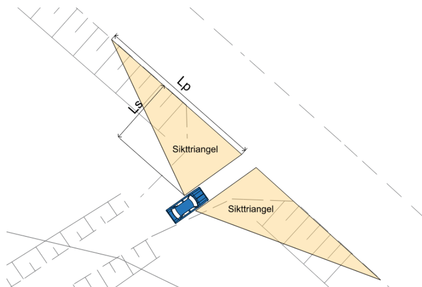
Illustrationen ovan redovisar hur siktlinjer vid korsning bedöms. L_p motsvarar längd primärgata och L_s motsvarar längs sekundärgata. Bild: Vara kommun.
